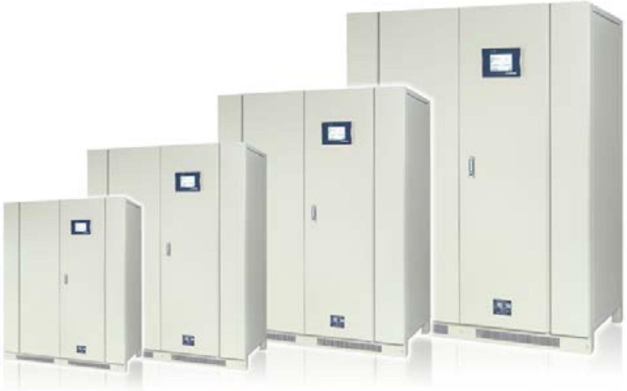
최첨단 32bit 고속 고성능의 DSP를 사용하여 완전 디지털 방식의 제품으로 가장 진보된 방식의 제어기술을 활용하여, Color 터치스크린을 이용 최적의 전원환경을 구현 하였습니다. Double conversion방식을 기본으로 하여 입,출력 절연변압기를 내장 한 True on-line UPS입니다. 고품질의 출력전압, 유동적인 부하변동에 우수한 작동, 무순단 절체시간, 과전압보호 및 여과기능은 가장 큰 특징입니다.
